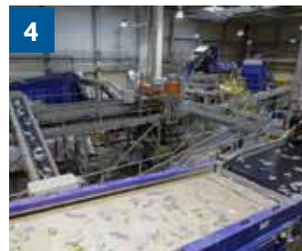
4 Vue d'ensemble des tapis qui conduisent les bouteilles triées vers les broyeurs.
