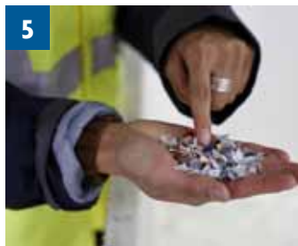
5 À la sortie des broyeurs, on obtient des paillettes de plastique.
