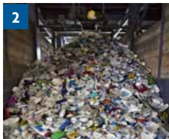
2 Les balles sont déconditionnées et les bouteilles entrent dans l'usine.
